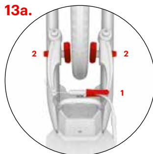
A hátsó fék beállítása (V-fék)
