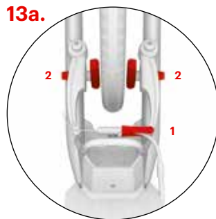
Ajuste del freno trasero (los frenos “V”)
