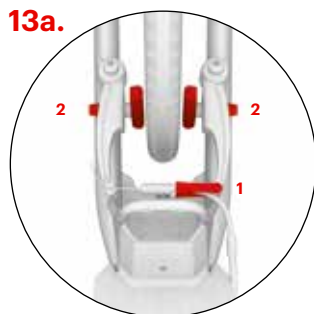
Seřízení zadní brzdy (V-brzda)
