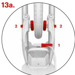
Настройка заднего тормоза (V-brake)
