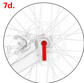
Montaje de la rueda trasera (freno de disco)
