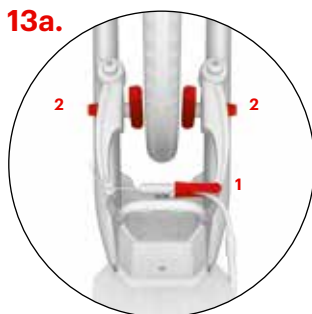
Podešavanje stražnje kočnice (V-kočnica)
