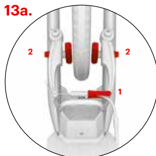
Regulacja hamulca tylnego (V-brake)
