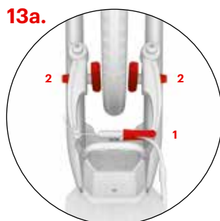
Nastavenie brzdy (V-brzda)
