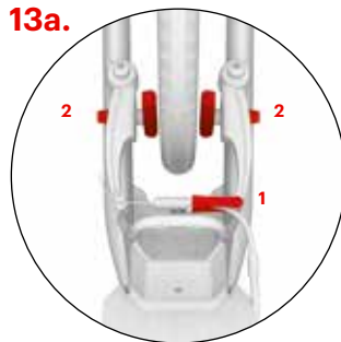
Justering av bakbromsen (V-broms)
