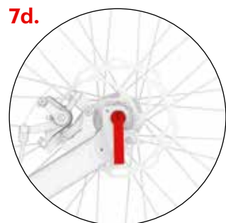
7d. Installazione della ruota posteriore (freno a disco)
