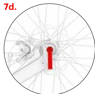
7d. A hátsó kerék beszerelése (tárcsafék)
