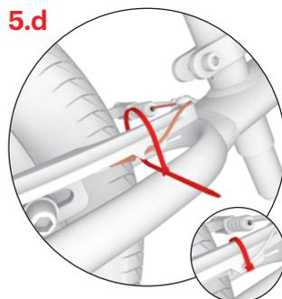
Koniec brzdového lanka zafixujte do zámku a zabezpečte sťahovacou páskou, pásku potom zastrihnite.
