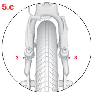
Pokud kolo při otáčení v některém místě škrτά o brzdový špalík, symetricky upravte vzdálenost brzdových ramen napínacími šroubky (3).
