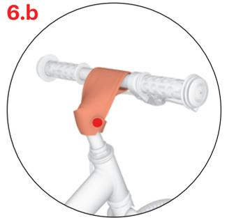
Schlagen Sie das Seitenband um die Säule des Lenkervorbaus und schließen Sie den Druckknopf.
