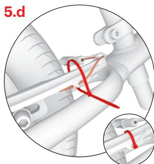
Przymocuj koniec linki hamulca do zamka zablokuj i zabezpiecz za pomocą paska. Pasek potem przytnij.
