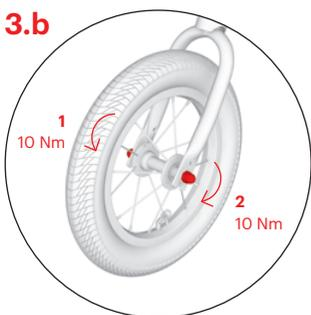
Поместите колесо в переднюю вилку строго по центру и затяните гайки (1, 2). (Для облегчения установки вы можете перевернуть беговел вверх ногами).
