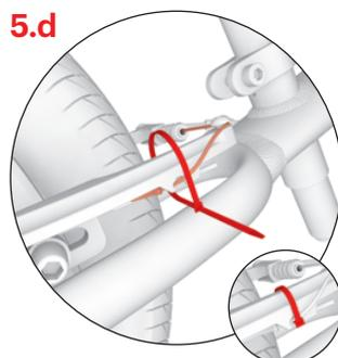
Fixer l'extrémité du câble de frein dans le verrou et la serrer ensuite avec un collier serre-câble. Couper le bout du collier qui dépasse.
