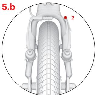
Skontrolujte, či sa brzdové doštičky pri uvoľnení brzdovej páčky dostatočne vzdialia od ráfika (1–2 mm). Vzdialenosť brzdových doštičiek je možné upraviť povolením alebo dotiahnutím brzdového lanka v kotviacej skrutke (2).
