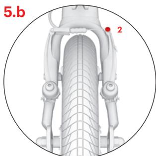
Sprawdź, czy po zwolnieniu dźwigni hamulca klocki wystarczająco odsunęły się od obrotki (1 - 2 mm). Odległość klocków można dostosować poprzez dociągnięcie lub poluzowanie linki hamulcowej w grubie mocującej (2).
