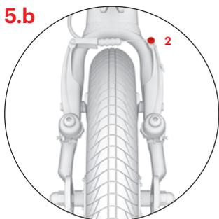
Zkontrolujte, zda se špalíky při uvolnění brzdové páčky dostatečně oddálí od ráfku (1–2 mm). Vzdálenost špalíků lze upravit přitážením či poveláním brzdového lanka v kotevním šroubu (2).
