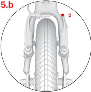
Überprüfen Sie, ob der Abstand der Bremsbeläge von der Felge bei unbetätigtem Bremshebel etwa 1–2 mm beträgt. Dieser Abstand lässt sich durch anziehen oder lockern des Bremsseils in der Fixierschraube (2) regulieren.
