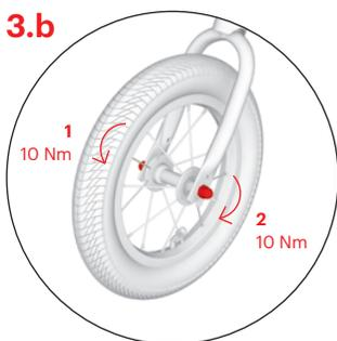
Następnie włóż koło do widelca tak, aby znajdowało się ono dokładnie w środku i dokręć nakrętki (1, 2). (Dla ułatwienia montażu można rowerka biegowego odwrócić do góry nogami).
