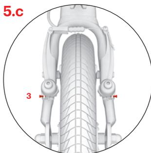
Pokiaľ sa koleso pri otáčaní v niektorom mieste dotýka brzdovej doštičky, upravte symetricky vzdialenosť brzdových ramien napínacími skrulkami (3).
