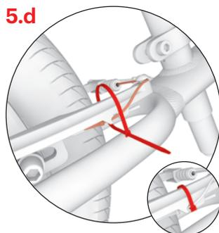
Konec brzdového lanka zafixujte do zámku a zabezpečte stahovací páskou, páskou poté zastříhnete.
