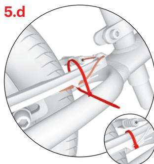
Conecta el extremo del cable del freno a la horquilla, sujétalo con una correa y córtala.
