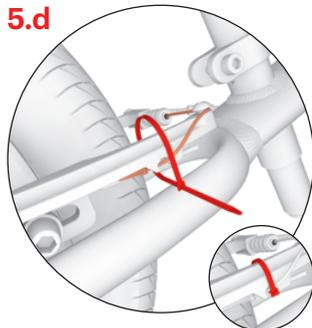
Закрепите конец троса тормоза в замке и закрепите его затяжным хомутом, затем отрежьте лишний конец.
