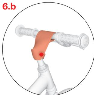
Оберните боковые клапаны вокруг стойки руля и защелкните кнопочное соединение.
