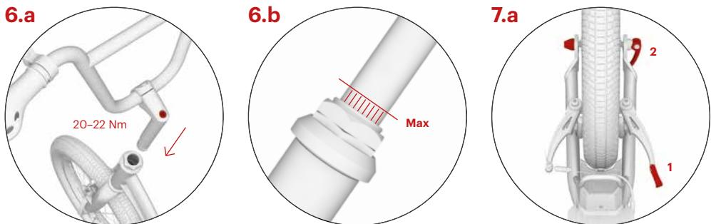
Představec zasuňte do trubky rámu koloběžky a nastavte požadovanou výšku říditek, max. však po vyznačenou rysku, viz obr. 6.b. Zkontrolujte, zda jsou řídítka rovně (kolmo k ose kola) a dotáhněte šroub na představci.
