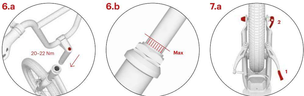
Predstavec zasuňte do rúrky rámu kolobežky a nastavte požadovanú výšku riadičiel, max. však po vyznačeném rysku, pozri obr. 6.b. Skontrolujte, či riadičia sú rovno a dotiahnite skrutku na predstavci.
