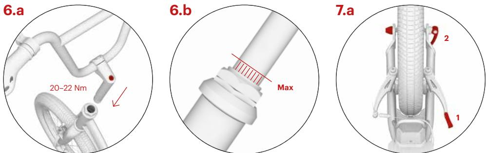
Włóz rdzeń kierownicy do otworu ramy hulajnogi i ustaw wysokość kierownicy uważając, aby nie umieścić jej powyżej zaznaczonej linii, patrz rys. 6.b. Upewnij się, że ramiona kierownicy są proste, a następnie dokręć śrubę na rdzeniu.
