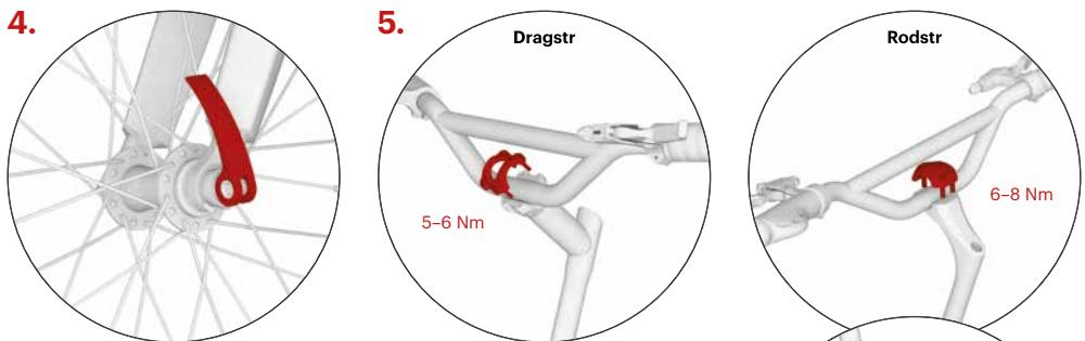
Resserrez l'écrou de réglage de l'attache rapide de sorte que vous sentiez juste avant de la fermeture de l'attache rapide une résistance sensible. Fermez l'attache dans une telle position qu'elle ne touche pas la fourche et en même temps que son ouverture accidentelle lors de l'utilisation soit empêchée.
