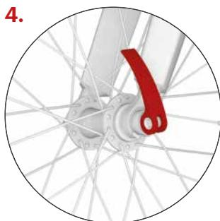
Dra åt inställningsmuttern av snabbfrigöringsmekanismen till rätt position. När det är i rätt läge kommer du att känna ett märkbart motstånd precis innan du stänger mekanismen helt. Stäng snabbfrigöringsspanken i ett läge där det inte kommer i kontakt med gaffeln och samtidigt inte kan öppnas av misstag när du åker.
