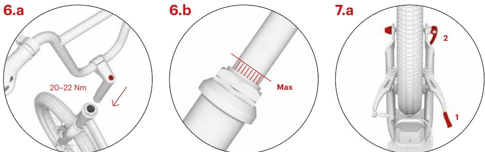
Inserte el vástago en el tubo del bastidor del patinete y ajuste la altura del manillar teniendo cuidado de no situarlo por encima de la línea marcada, véase img. 6.b. Asegúrese que el manillar está recto (perpendicular al eje de la rueda) y luego apriete el tornillo en el vástago.
