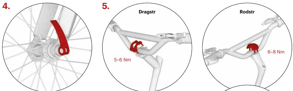
Zategnite maticu za namještanje zatvarača kotača tako da neposredno prije zatvaranja poluge zatvarača osjetite znatan otpor. Polugu zatvorite u položaju u kojem ne dodiruje vilicu, a istovremeno ne može doći do slučajnog otvaranja tijekom vožnje.
