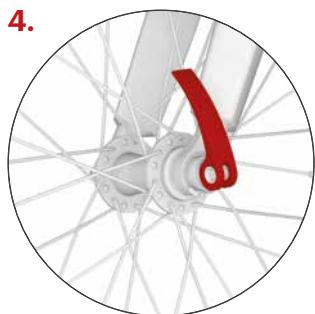
Apriete la tuerca de ajuste del mecanismo de cierre rápido hasta la posición correcta. Cuando alcance la posición correcta, notará una resistencia evidente justo antes de que cierre el mecanismo por completo. Cierre la palanca del cierre rápido a una posición en la cual no toque la horquilla y simultáneamente no pueda abrirse de forma accidental al usar el patinete.
