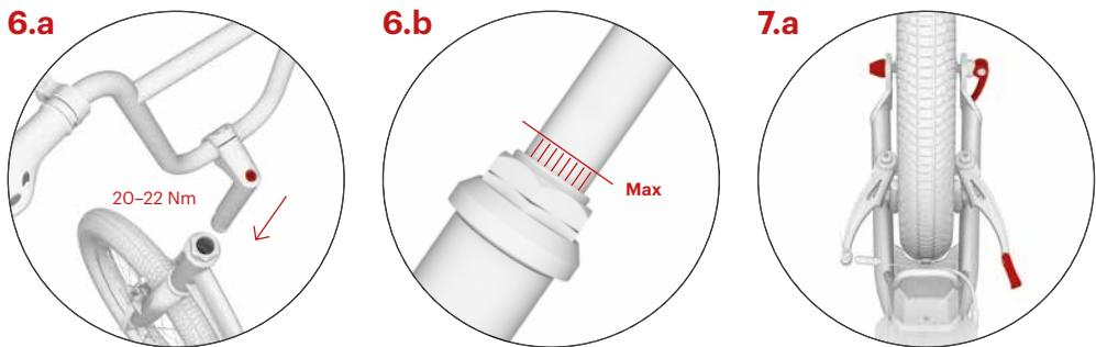
Introduisez la potence dans le tube du cadre de la trottinette et réglez la hauteur souhaitée du guidon en respectant la hauteur maximale marquée - voir image 6.b. Vérifiez si le cintre est droit (perpendiculaire à l'axe de la roue) et serrez la vis sur la potence.
