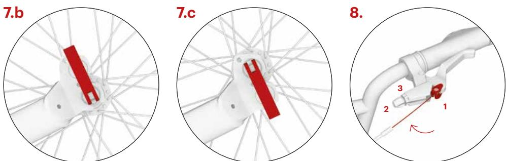
La horquilla trasera de dos posiciones le permite ajustar la altura sobre el suelo de la plataforma de apoyo. Utilice la posición más baja para conducir sobre un terreno difícil. Cierre la palanca de cierre rápido. Tiene que apuntar hacia arriba.
