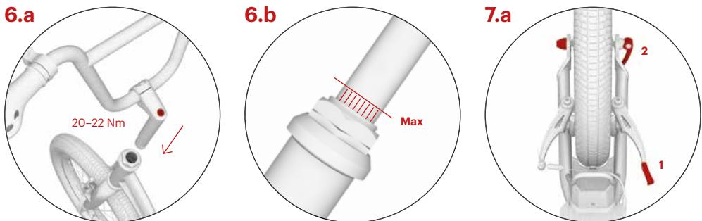
Рулевую колонку вставьте в трубу рамы самоката и установите желаемую высоту рукояток, но не выше ограничительной риски (см. рис.6б). Убедитесь, что рукоятки размещены правильно (перпендикулярно плоскости колеса) и затяните болт на выносе.
