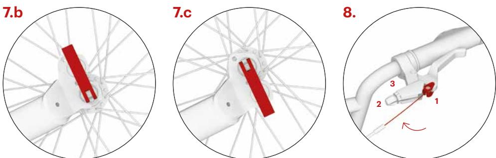
Die hintere Gabel mit zwei Positionen ermöglicht die Einstellung der Trittbreithöhe. Die untere Gabelhalterung ist für Geländefahrten bestimmt. Schließen Sie den Schnellspannhebel so, dass er nach oben zeigt.
