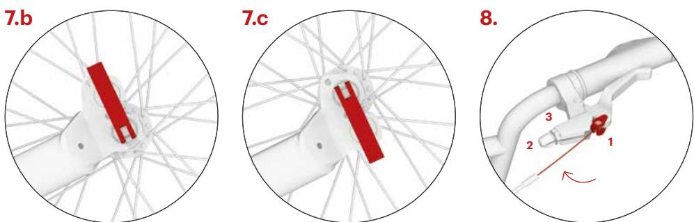
La fourche arrière à deux positions permet d'ajuster la hauteur du repose-pied au-dessus du sol. Utilisez le support inférieur pour une conduite plus sportive. Fermez l'attache rapide de sorte qu'elle soit orientée vers le haut.
