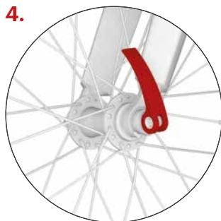
Stringere il dado dello sgancio rapido fino sterzo a sentire una discreta resistenza prima leggero di chiudere completamente la levetta. Chiudere la levetta verso l'alto in modo da non toccare la forcella ed allo stesso tempo evitare una apertura accidentale durante la corsa.
