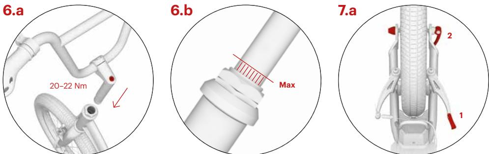
Schieben Sie die Lenkerstange in das Hauptrohr des Tretrollerrahmens und stellen Sie die gewünschte Höhe des Lenkers ein (bis max. in Höhe des gekennzeichneten Striches, siehe Abb. 6.b). Überprüfen Sie, ob der Lenker gerade ist und ziehen Sie die Schraube der Lenkerstange fest.
