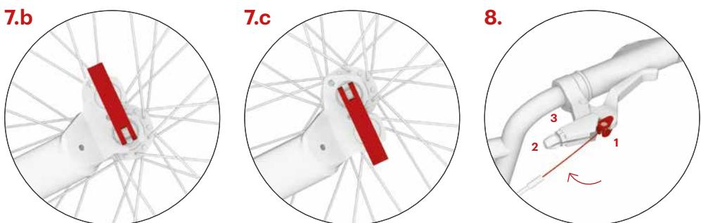
Двухпозиционная задняя вилка позволяет приспособить высоту деки. Нижнюю скобу используйте для езды по бездорожью. Эксцентрик закройте так, чтобы его рычажок был направлен наверх.
