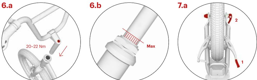
Inserire l'asta del manubrio nel tubo dello sterzo del monopattino e regolare l'altezza desiderata, senza oltrepassare la tacca (vedi fig. 6b). Controllare che il manubrio sia diritto (perpendicolarmente all'asse della ruota) e serrare la vite sull'asta.
